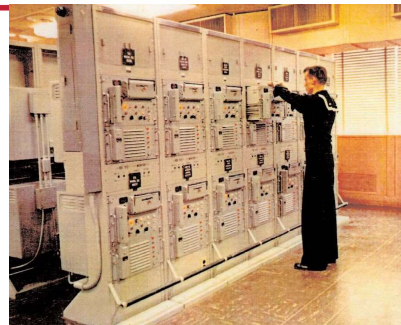
Hệ thống máy mật mã điện tử KW-26 (1957) được Hoa Kỳ đưa vào sử dụng
